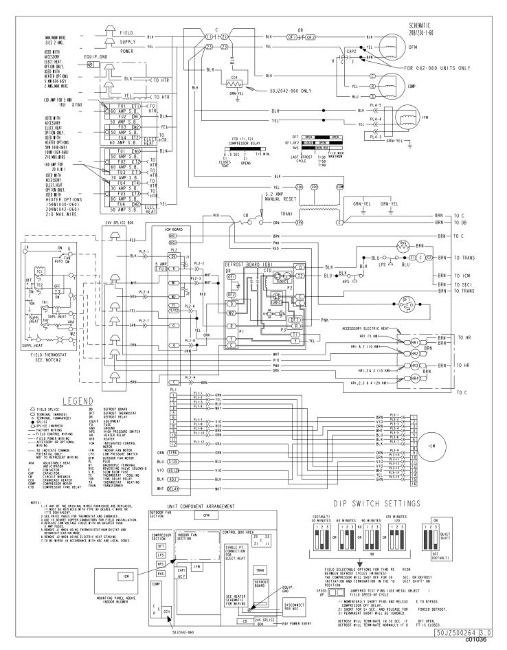
Fig. 17—ICM FIOP Electrical Schematic—50JZ
